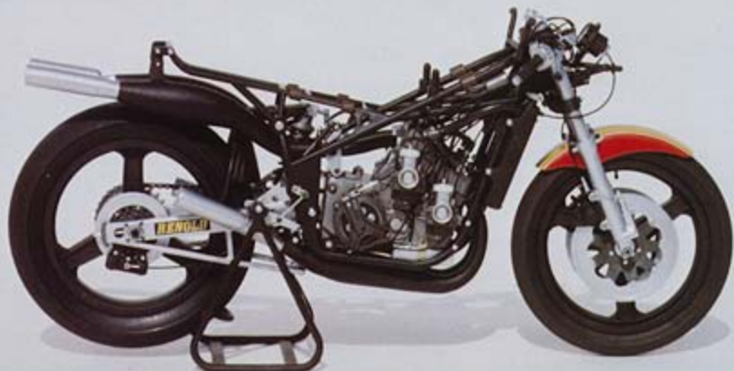
Fig.1. La rimozione della carenatura e del serbatoio rivela il dettagliatissimo motore a quattro cilindri raffreddato ad acqua.
